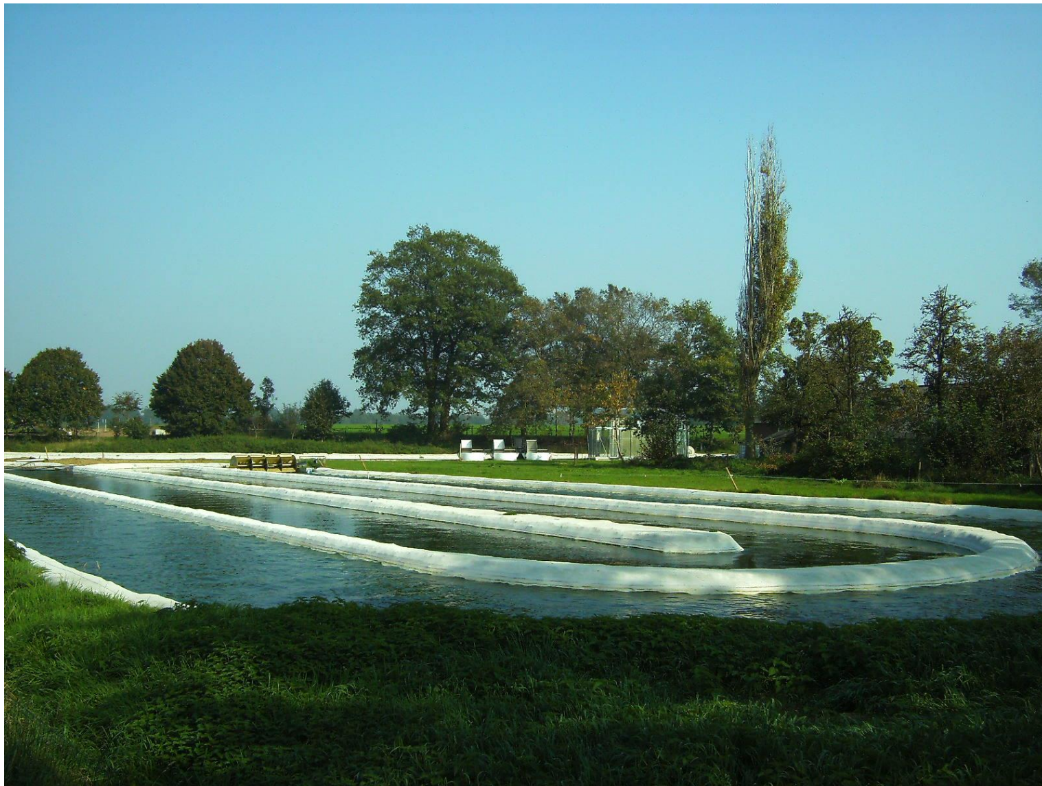
Nyitott rendszerű fotobioreaktor
