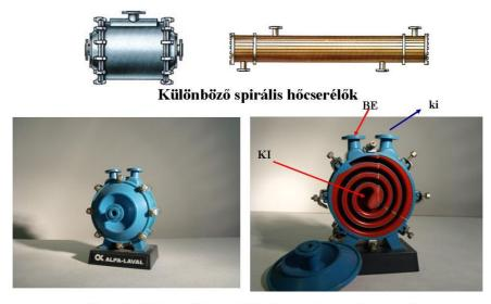
**Spirális hőcserélő modellje és a szétszerelt modell** *Fig 4.152.: Spiral heat exchanger*
