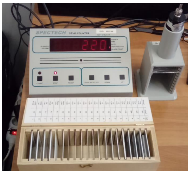
7. ábra: A mérésnél használt ST360 számláló, GM-cső és abszorbens készlet
