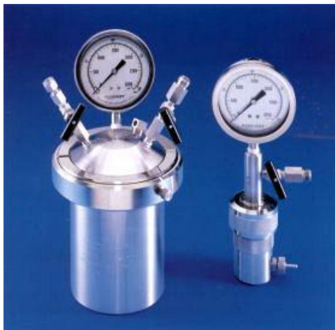
3.5.1.3.1. ábra: Dekompresziós bombák (katalógusfotó)
