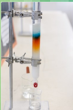
1. Ábra: szakaszos kromatográfias oszlop
