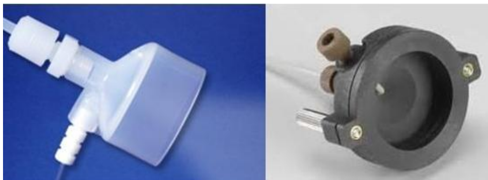
2.4.2.3. ábra. Szögporlasztók ICP-OES-készülékhez
