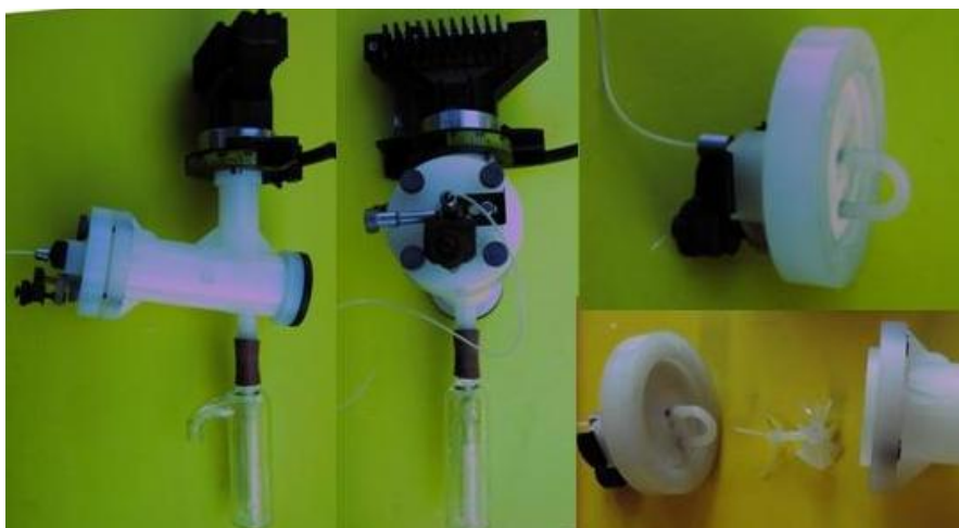
2.5.4.2. ábra. A láng-AAS-készülék porlasztó-égő egységének fényképe
