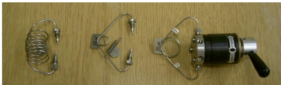
2.2.5.7. ábra. HPLC-injektor cserélhető adagolóhurkokkal
