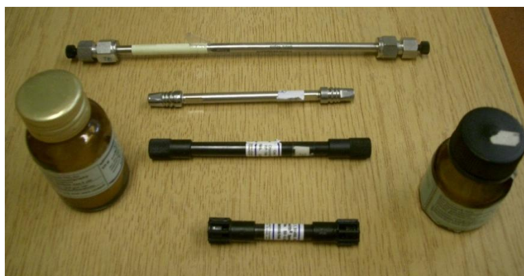
2.2.5.6. ábra. HPLC-oszlopok és -töltetek (üvegben)
