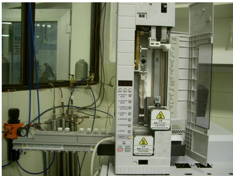
2.2.5.2. ábra. Automata mintaadagoló gázkromatográfhoz
