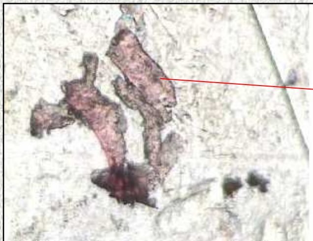
Ellapított és lemaszkolt elemi szál mikroszkópi képe a fémlap felületén
